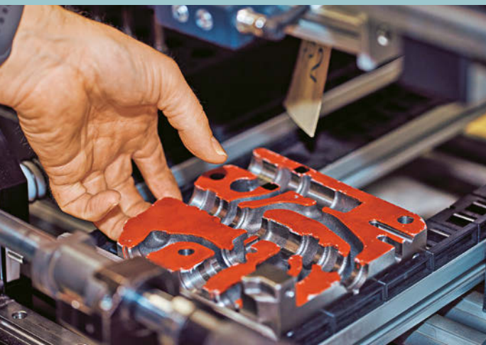
Dieses Schnittmodell veranschaulicht die Komplexität eines Traktorventils.
